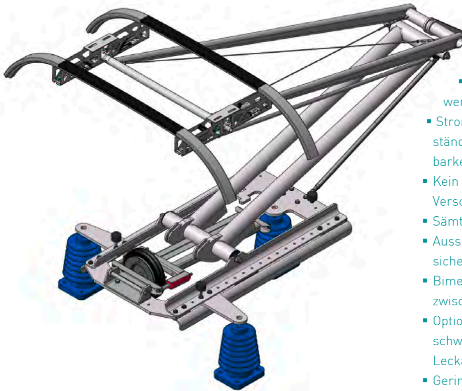
Bild: Schematische Darstellung Halbscherenstromabnehmer (kundenspezifische Ausführung)
