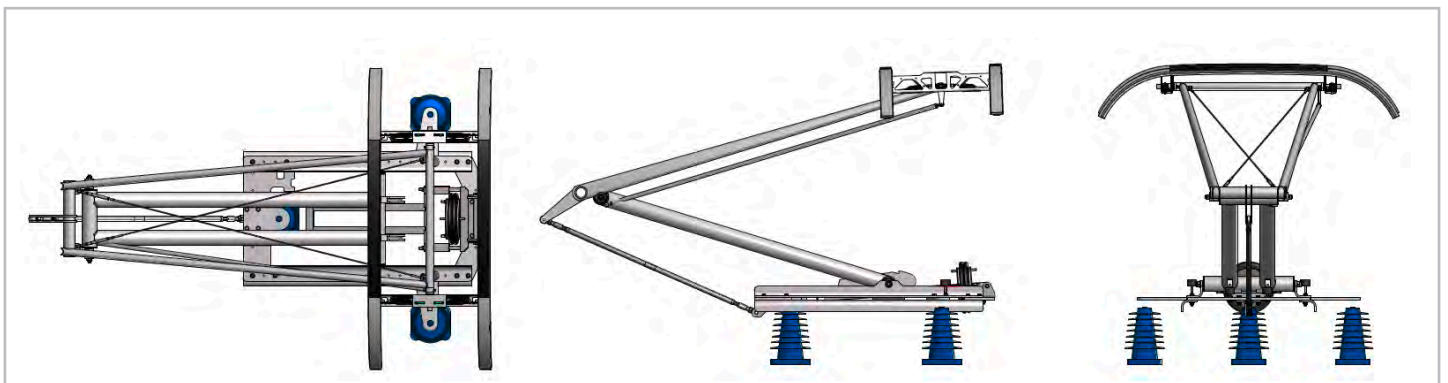
Bild: Schematische Darstellung Halbscherenstromabnehmer (kundenspezifische Ausführung)
