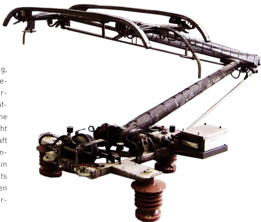
Bild: Serienstromabnehmer mit integrierter Messtechnik
